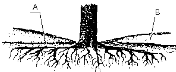
Rys. 3. Niecka o łagodnym pochyleniu, dostosowująca drzewo do otaczającego terenu podwyższonego o 0,2 \div 0,4
