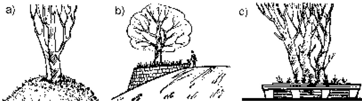
Rys. 2. Zabezpieczenie drzew przy obniżeniu terenu, po wykonaniu wykopów
